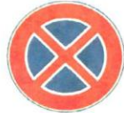
ممنوع الوقوف و التوقف Arrêt interdit No waiting on main carriage way
